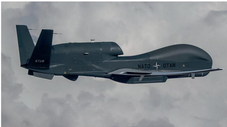
Drone HALE RQ-4D Phenix, version en service à l'OTAN des RQ-4B Global Hawk de l'USAF. Les deux types sont actuellement stationnés sur la NAS de Sigonella en Sicile
