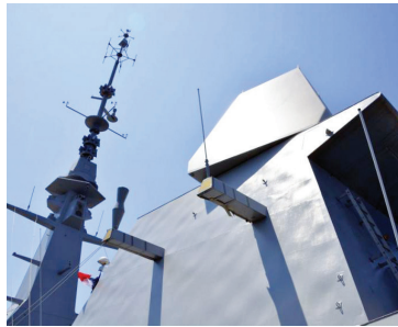
Mât « Alsace », radar Herakles (Copyright Naval Group)
