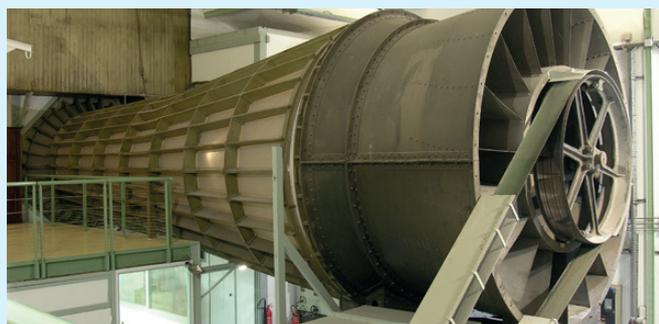
La Soufflerie Eiffel réalise de nombreux essais pour simuler les effets du vent et de l'air sur des maquettes d'éléments de construction, d'avion, de voiture.
