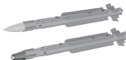
Missiles MICA, en haut : autodirecteur électromagnétique, en bas : autodirecteur infrarouge (Copyright MBDA)
