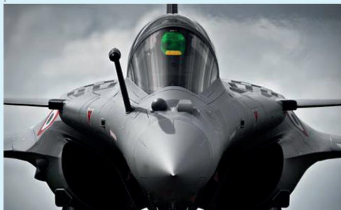
Une partie des antennes SPECTRA sur la face avant du Rafale
