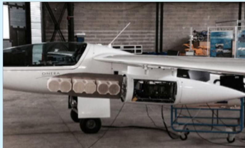
Système complet de réception spécialement développé pour le projet, intégré dans le pod de moto-planeur. © ONERA
