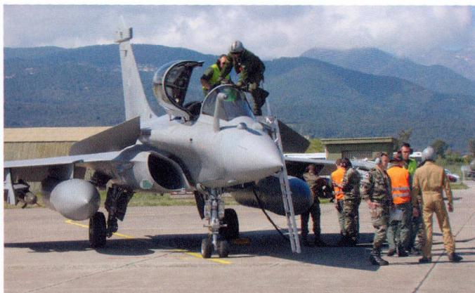
Un Rafale en configuration multi-rôle avec AASM et missiles air-air MICA (infrarouge et électromagnétique). Les opérations en Libye en 2011 consacrent la polyvalence du Rafale, incluant des tirs de missile croisière Scalp EG, mais aussi des missions de Renseignement temps réel avec le système Reco NG et de ravitaillement en vol.
