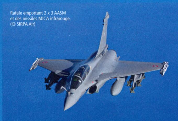
Rafale emportant 2 x 3 AASM et des missiles MICA infrarouge.
