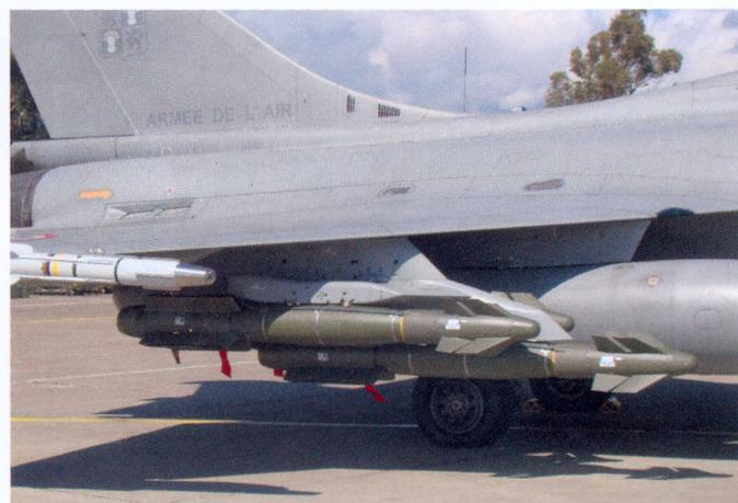
Configuration tri-bombe du AASM (Armement Air-Sol Modulaire) et MICA sous un Rafale du 1/91 Gascogne.
