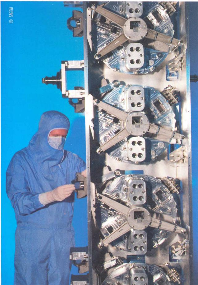
En salle blanche chez Sagem, l'assemblage final d'une Unité Remplaçable en Ligne, composante optomécanique de la Section Amplificatrice Hors Amplification du Laser MégaJoule.
