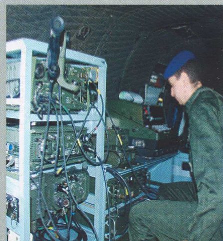
Ci-contre, déploiement du futur PC-Aéro de l'EM 4 e BAM. Ci-dessus, intérieur d'un Puma-PC équipé de ses moyens SCIF montés sur racks démontables.
