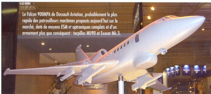
Le Falcon 900MPA de Dassault-Aviation, probablement le plus rapide des patrouilleurs maritimes proposés aujourd'hui sur le marché, doté de moyens ESM et optronique complets et d'un armement plus que conséquent : torpilles MU90 et Exocet Mk.3.
