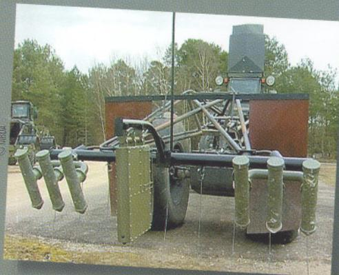
En opérations, DEDALE permet de protéger la charrue de déminage d'un engin de brèche, confère aux véhicules d'accompagnement des chars une réelle capacité de désengluement et, enfin, permet d'assurer des missions de sécurisation d'itinéraire. Mission primordiale en OPEX où les forces sont comptées.
