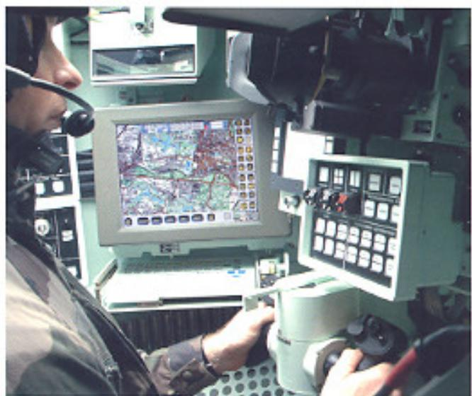
permet le contrôle des moyens de dialogue et de la régie vidéo. Il génère automatiquement certains paramètres lors de l'émission de messages d'alerte (heure système, nombre de munitions dans le chargement automatique, quantité de carburant restante).
