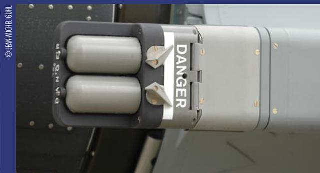
Ci-dessus, nouveauté : les Rafale C/F2 de l'Escadron de Chasse 1/7 "Provence" sont désormais dotés de la nouvelle version de l'ensemble d'autoprotection électronique SPECTRA de Thales qui dispose de nouveaux logiciels plus intuitifs et qui gère également les lance-paillottes MBDA Spirale, peu ou prou identiques à ceux qui équipent les Mirage 2000. La disposition verticale des moulinettes, placées de part et d'autre des moteurs M88, assure une dispersion encore plus grande des "chaffs".
