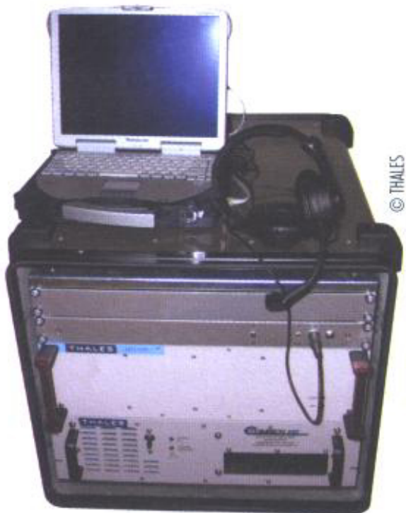
Le Force Protection Jammer (FPJ) de Thales, brouilleur de communications intelligent destiné à protéger les convois terrestres contre les explosifs détonnés à distance par radio ou à interdire les liaisons de forces éventuelles placées en embuscade.
