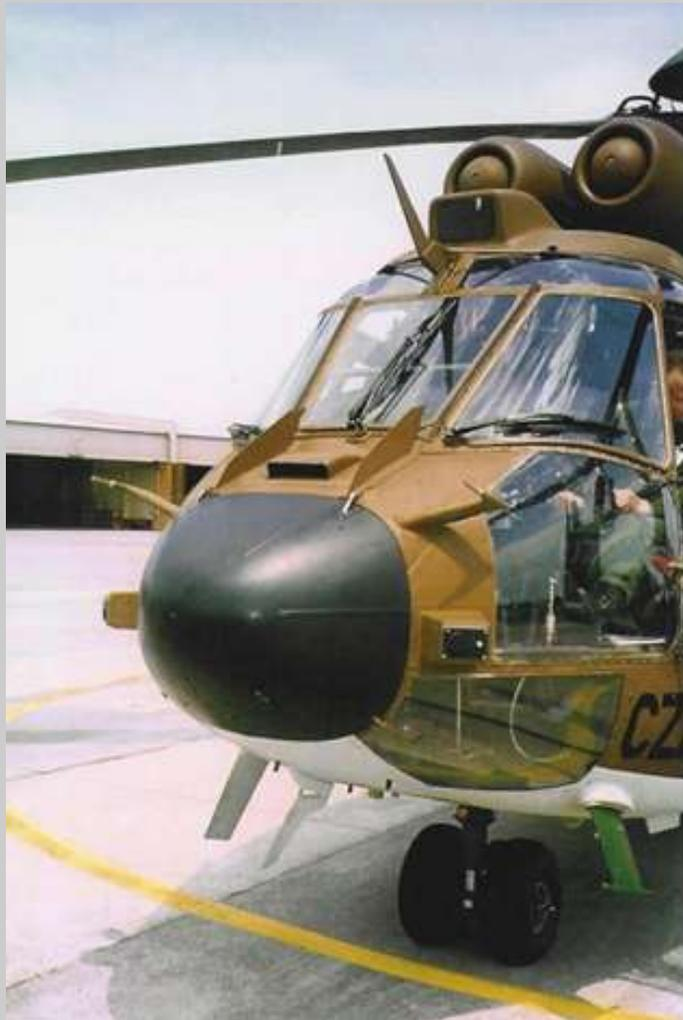
*Le détecteur d'alerte radar Fruit sur un Cougar Horizon*
