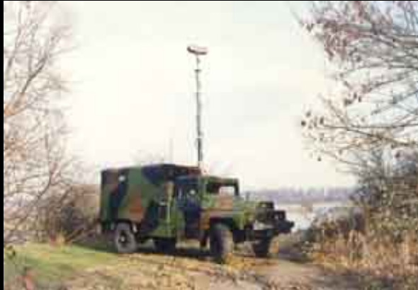
Véhicule STAIR de renseignement ELINT du 54e RT de la BR de l'Armée de Terre sur camion ACMAT
