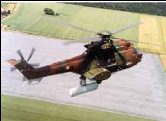
Cougar Horizon du 1er RHC de Phalsbourg avec son radar déployable conçu par THALES
